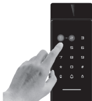
7.按2进入无线功能， 先按2删除无线设备， 再按1配对无线设备， 门锁提示“无线配对中”， 回到手机
