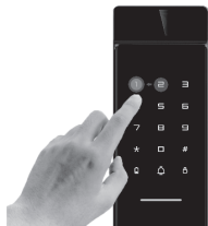
6.按2进入无线功能，先按2删除无线设备，再按1配对无线设备，门锁提示“无线配对中”，回到手机
