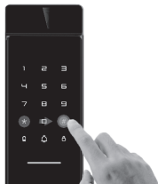
4.切换到门锁端，依次输入★和#，进入系统设置
