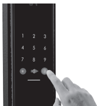
5.切换到门锁端,依次输入★和#,进入系统设置
